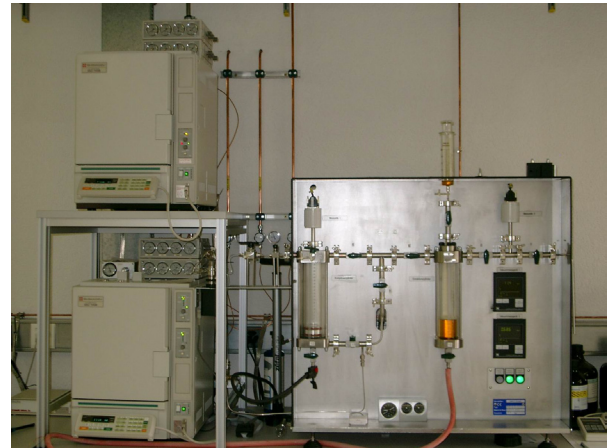
à droite : Appareillage pour l'extraction du gaz à gauche : Chromatographes pour la détermination des gaz
