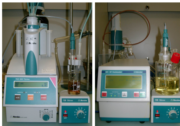
à gauche : Détermination de l'indice de neutralisation à droite : Détermination du taux d'humidité
