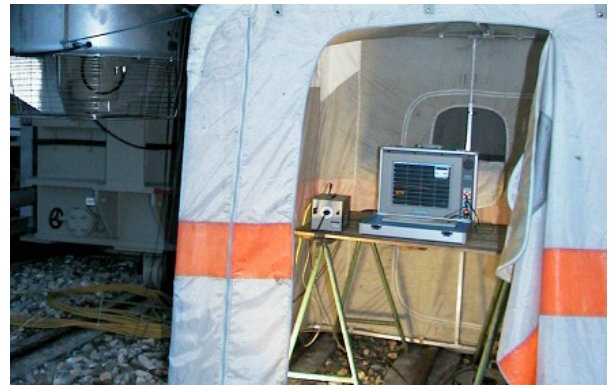
Instrument PDC pour mesures des courants de polarisation et dépolarisation sur site
