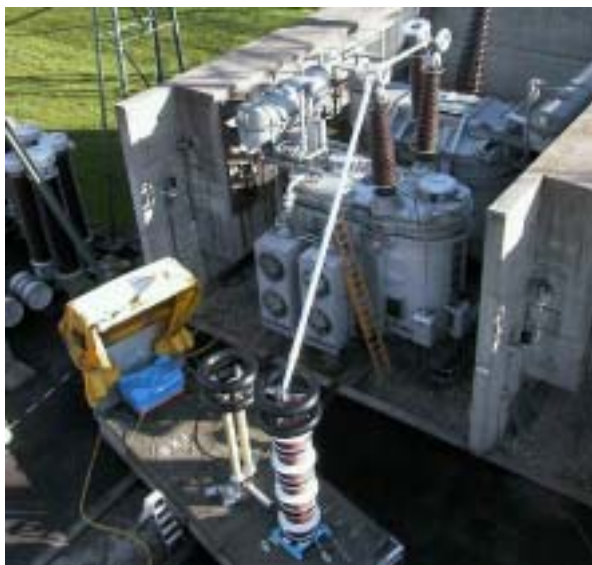
Bild 2 Fremdspannungserzeugung mit einer Serie-Resonanz-Anlage (variable Frequenz, feste Induktivität, Schema: dreiphasiger, separater Regulierpol, Foto: einpoliger, separater Regulierpol)
